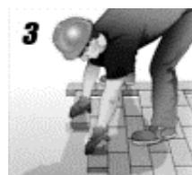
3 Posa del pave'. La posa in opera deve essere condotta in modo tale da mantenere sempre un fronte "aperto" per la posa dei masselli successivi, onde evitarne l'inserimento forzato. È buona norma prelevare il materiale per la posa contemporaneamente da almeno 3 unità di confezionamento, al fine di garantire una maggiore uniformità cromatica. La posa può essere fatta anche con mezzi di sollevamento appropriati.
