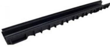
CANALE **COMPACT** in polipropilene copolimero caricato con anti U.V., è ideale come sistema di drenaggio delle acque semplice ed efficace. Può essere impiegato su solai di ridotto spessore (es. terrazzi) per la sua altezza contenuta.
